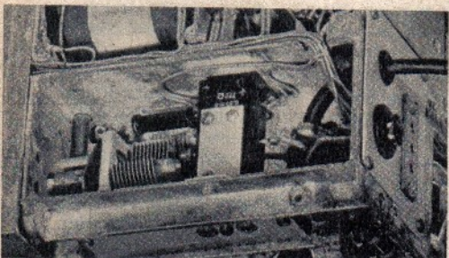
Abb. 6b. In der linken unteren Kammer des FuG-16-Gestells ist der Ant.-Kondensator und der Stromwandler eingebaut. Hinten bei der Einführung des Netzkabels erkennt man den Sicherungshalter und die Dreifachbuchse für den Anschluß des Sendeschalters und Modulators
